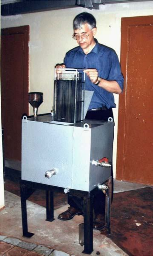
Рис.3. Установка коалесцирующего фильтра (блока) в установку «Флотатор-У».
